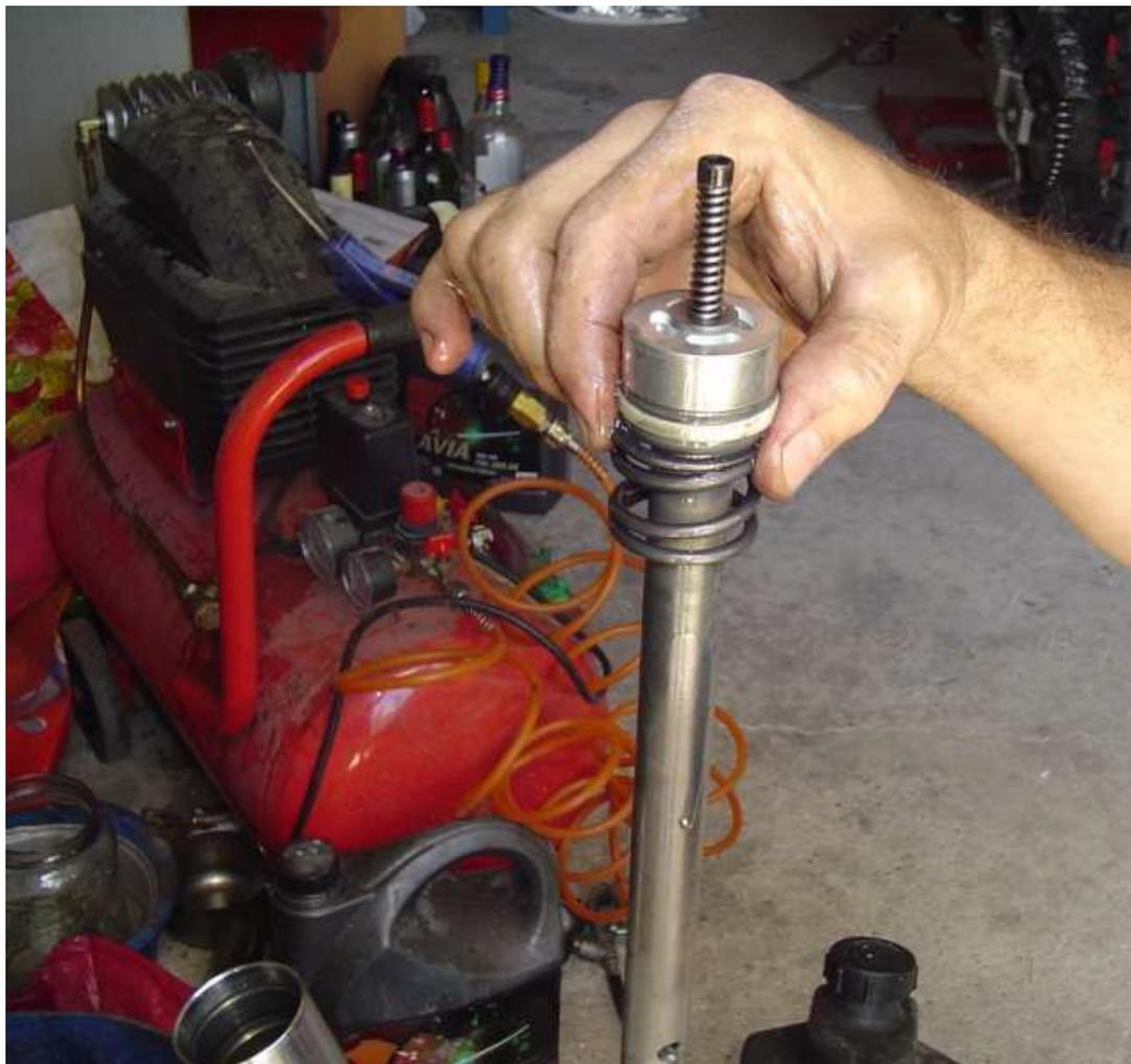
on verifie que le clapet soit bien dans l'axe du tube ,un fois le gros ressort dessus il sera maintenu...
