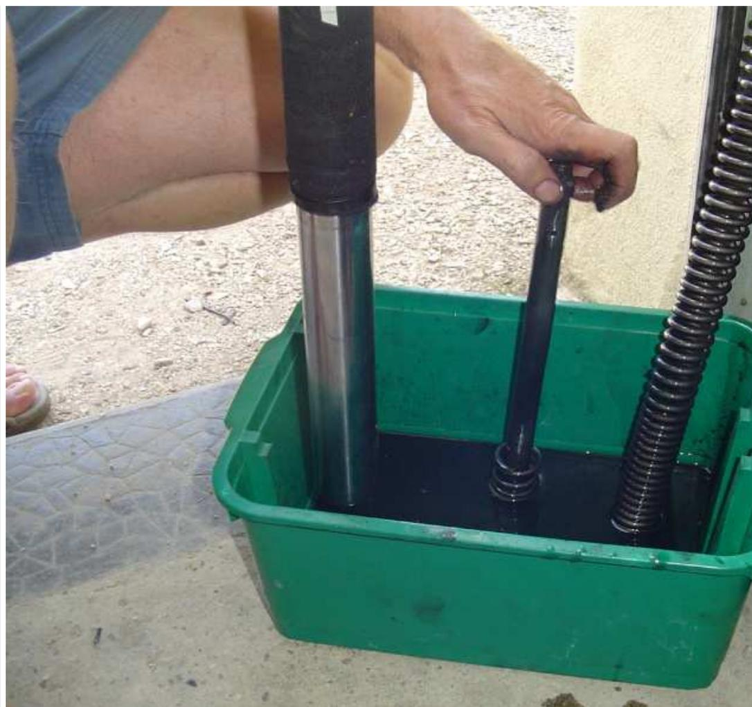
là les tubes d'origines avec leurs trous du bas (des nuances de diamètre et de nombre suivant les modèle
